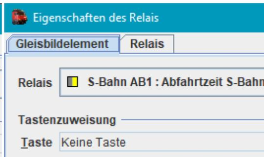
Für jede Zeit-Spalte, „an“-Spalte und „ab“-Spalte wird ein Relais angelegt und entsprechend benannt.
